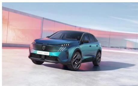
Comme pour la DS 3 E-Tense, le moteur est fabriqué en France. Celui-ci est associé à une **batterie NMC** (nickel – manganèse – cobalt) de 73 et 93 kWh, offrant une **autonomie** comprise entre 525 et 700 kilomètres selon le cycle WLTP
