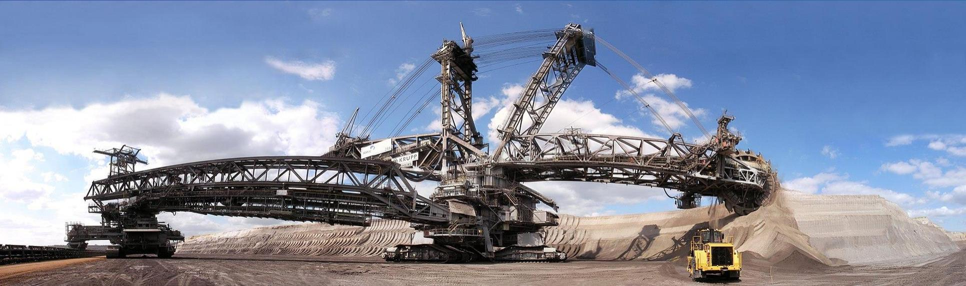
Roue à 18 godets, d'une capacité unitaire de 6,6 tonnes de terre
