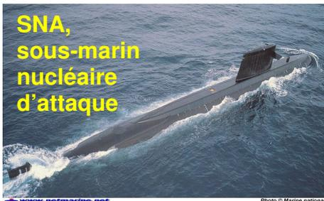
Dès 1942 (divergence de la première pile nucléaire), la capacité de disposer d'une source d'énergie anaérobie\* quasi-illimitée a permis d'assurer l'autonomie recherchée pour les sous-marins non seulement pour assurer leur propulsion, mais aussi toute la vie à bord (épuration d'air et usine d'oxygène, approvisionnement en eau par dessalement d'eau de mer) ; pratiquement, la durée des missions est désormais limitée par la nourriture et la capacité d'endurance des équipages.
