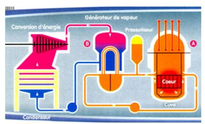
Les chaufferies des SNLE\* de type « Redoutable » sont des réacteurs à eau pressurisée (REP\*), suffisamment compacts pour pouvoir être embarqués.
