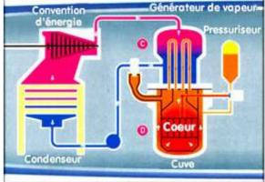
Pour les sous-marins d'attaque, une conception originale a été développée : le GV est placé directement au-dessus du cœur. Outre le gain de place, cette conception supprime le risque de rupture de la liaison cœur-GV, qui constitue le principal accident sur un réacteur nucléaire (dépressurisation et perte du refroidissement).
