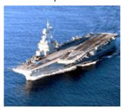
Déplacement = 40 600 tonnes Dimensions hors tout = 261,5 m x 64,4 m 2 catapultes de 74 m 1 îlot (le PA2 devrait en avoir 2) 8 ponts sous pont d'envol Puissance propulsive maximale continue = 56 MW 2 lignes d'arbre Vitesse de pointe = 27 nœuds Il dispose de 2 réacteurs de type K15.
