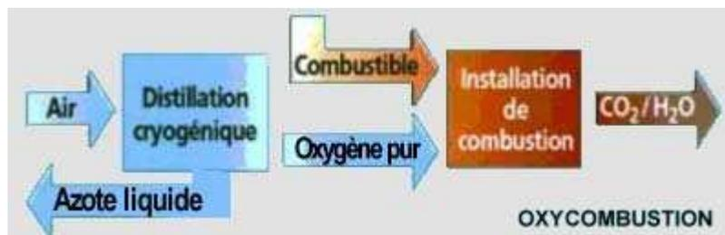
Avec le recyclage d'une partie du CO<sub>2</sub>, l'oxycombustion est bien adaptée à une remise à niveau d'une installation existante.
