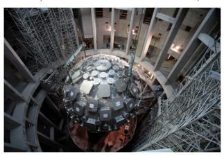
l'arme. Il est dimensionné pour que l'énergie apportée par les faisceaux laser conduise à la fusion de quelques milligrammes d'un mélange de deutérium-tritium. Il permettra d'atteindre en laboratoire des conditions thermodynamiques (densité, pression, température) extrêmes, similaires à celles rencontrées lors du fonctionnement nucléaire de l'arme.
