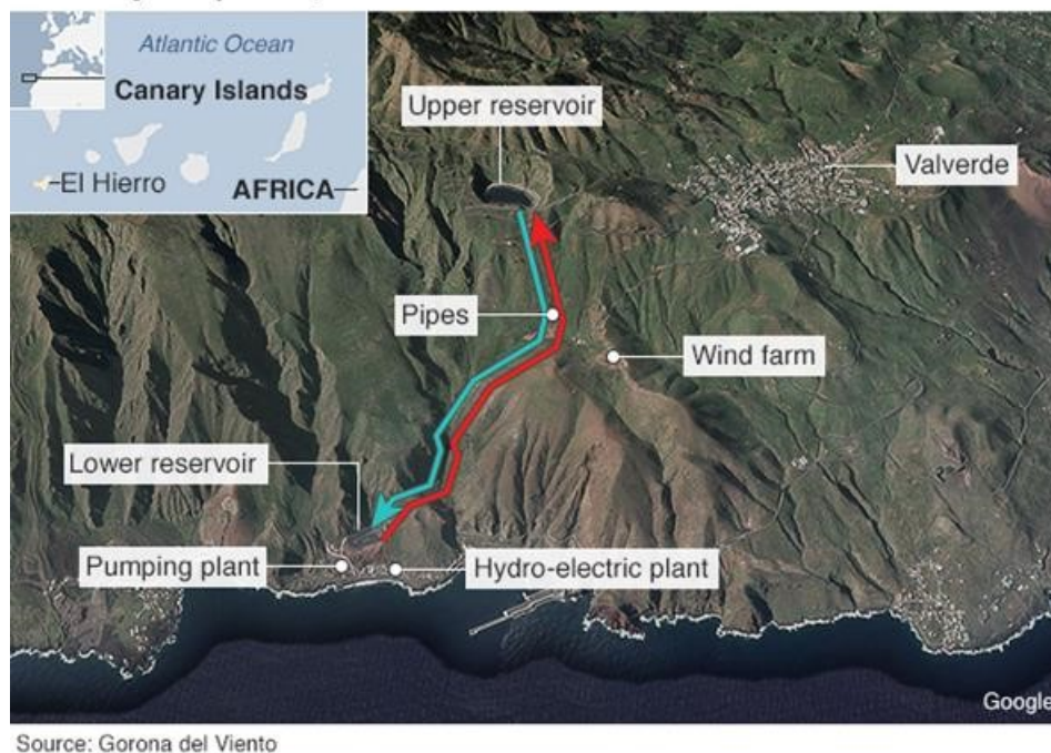
Fig.1 Implantation du système de production électrique de Gorona del Viento. La figure ne montre pas la centrale diesel de Llanos Blancos située près de la côte au voisinage de la station de pompage.
